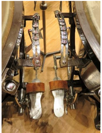
中央のペダル。それと連携して上にゲージがある。G、A、Hなどの印と矢印が見える。
